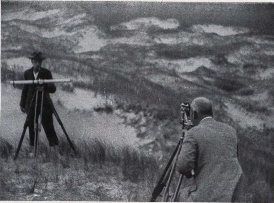
Der Photogrammeter bei der Standortbestimmung und Basismessung
