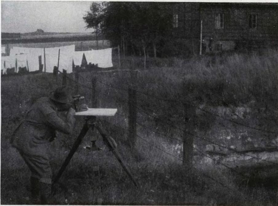
Einmessen einer Hausecke mit Kippregel und Meßplatte
