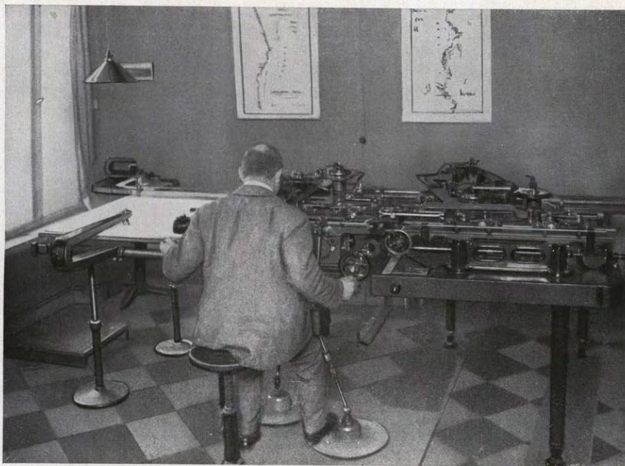
Der Photogrammeter beim Ausmessen der Aufnahmen mit dem Stereoautographen
