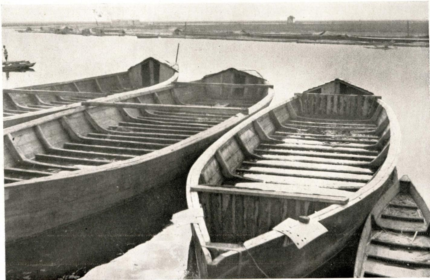
90. Typische, **flachgehende Lastenkähne**, wie sie im Dampferschlepp ostwärts Pinsk auf dem ganzen Pripet im Gebrauch sind.
