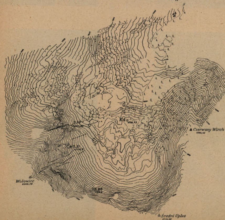
Ryc. 7. Odcinek terenu, opracowany na aerokartografii Huguershoff'a ze zdjęć terrofotogrametrycznych (ryc. 6a i 6b).
