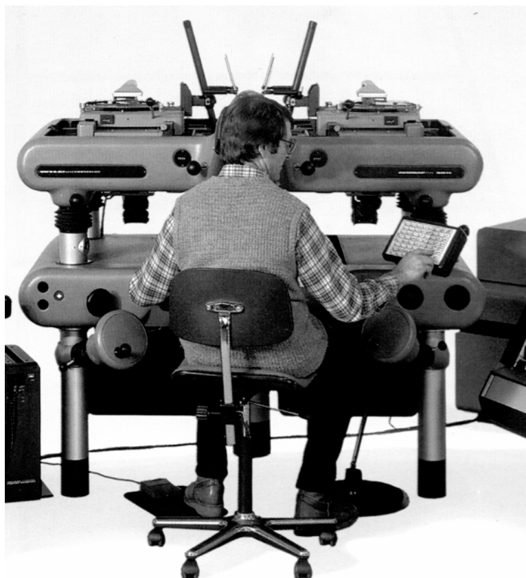
Rys. 3.10. Autograf Wilda Aviomap – widoczne są drążki rekonstruujące parę promieni rzucających. Operator przemieszcza przestrzenny znaczek pomiarowy ruchami 2 pokręteł ręcznych ( X , Y ), oraz tarczy nożnej ( Z ).
