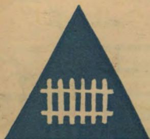
Zamykane przejazdy kolejowe
