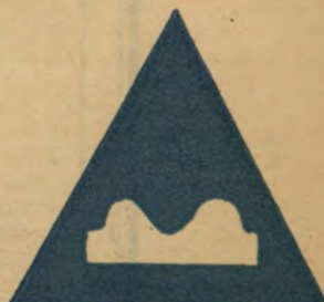
Wygórowane mostki i poprzeczne ścieki
